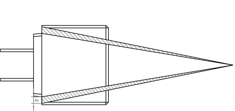
4- Sostentando la pieza como se muestra en la imagen, con bridas sujetando los laterales, colocar introduciendo las barras de corrugado en los orificios.
